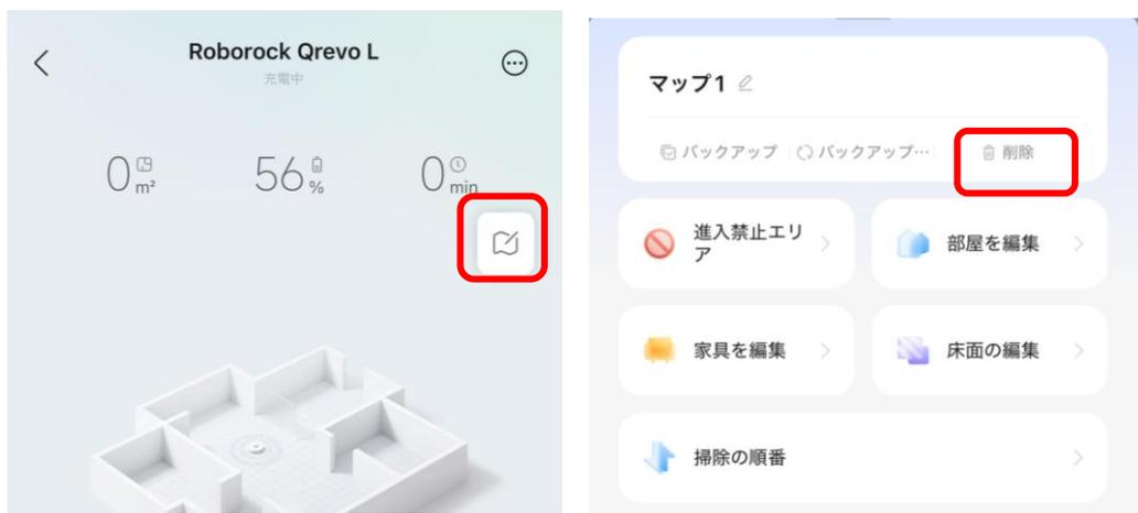
①赤枠のマークをタップしてマップ編集メニューを表示し、「削除」をタップします。
