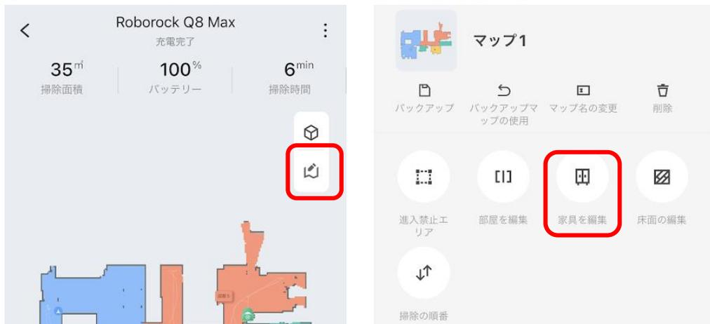
①右上の赤枠をタップしてマップ編集メニューを表示し、「家具を編集」をタップします。
