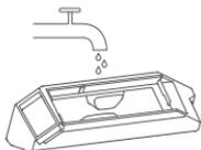
4. ダストボックスとエアフィルターは24時間以上を目安に完全に乾かしてから取り付けてください。
