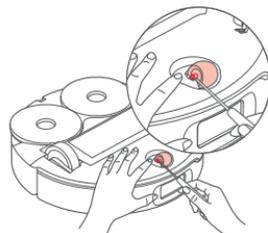
3. 車軸と車輪を水ですすいで、髪の毛や汚れを取り除きます。車軸と車輪を乾かし、ブラケットに押し込んで元通りに取り付けます。
