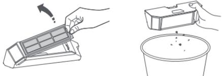
3. 水道水をダストボックスに入れて、エアフィルターを再度取り付けます。ダストボックスを軽く振って洗浄し、汚れた水を捨てます。
