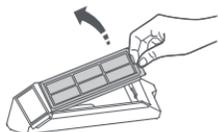
2. 取り外したエアフィルターを繰り返し水ですすいで、フレームを軽く叩いて汚れを落とします。
