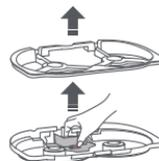
3. 洗浄トレーフィルターを洗浄トレーの元の位置に取り付けてから、洗浄トレーモジュールを、ドックに取り付けます。
