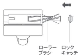
6. ロックキャッチを時計回りに回転させて、ロック位置にし、ローラーブラシを正しく取り付け直します。
