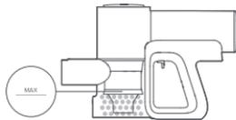
1. ダストボックスを空にする前に電源から外し、本機の動作が停止していることを確認してください。延長パイプまたはヘッドパーツを取り外します。ゴミ捨てボタンを押して、ダストボックスを空にします。
