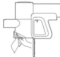
**注:** 掃除機内部の電気部品の損傷を防ぐため、掃除機本体またはダストボックスを水洗いしないでください。
