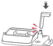
3. 延長パイプホルダーを取り外すには、背面の取り外しボタンを押し、ホルダーを上引き上げます。
