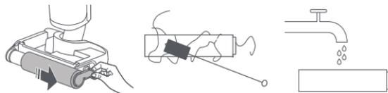
4. ローラーブラシを交換する必要がある場合は、ローラーブラシのキャップ全体をつかんでローラーブラシから引き抜きます。その後、ローラーブラシのキャップを新しいローラーブラシに取り付けます。
