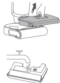
3. ローラーブラシ取り外しタブをつかみ、本体ヘッドに沿ってローラーブラシを引き出します。付属のお手入れツールを使用してローラーブラシの汚れを取り除き、きれいな水で洗い流します。
