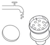
3. スポンジフィルターとマルチサイクロンユニットは、24時間以上乾燥させ、完全に乾かします。
