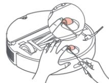
3. 車軸と車輪を水ですすいで、髪の毛や汚れを取り除きます。車軸と車輪を乾かし、ブラケットに押し込んで元通りに取り付けます。
