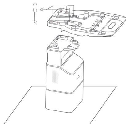
**注意:** ドックを逆さまにするときは、ゴミ収集ボックスカバーの落下に気を付けてください。
