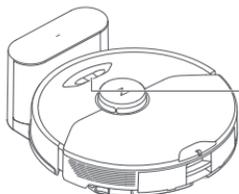
電源ランプの色がバッテリー残量を示します。
